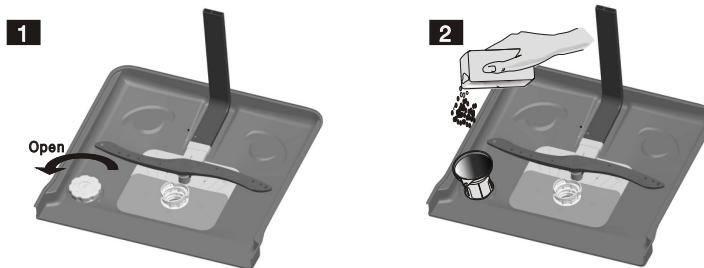
1. Entfernen Sie den unteren Spülkorb und schrauben Sie den Deckel des Behälters ab.
